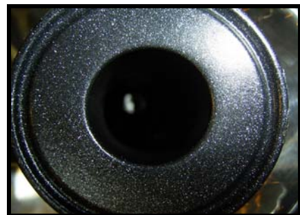
Rørstykke belagt med Accofal 2G54
